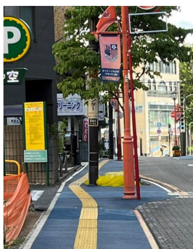
歩道の真ん中に電柱。点字ブロックはよけるように蛇行
